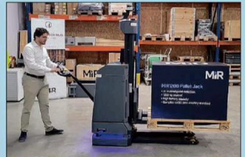
Le MIR1200 Pallet, en cas de besoin le personnel peut intervenir et le passer en semi-automatique.
